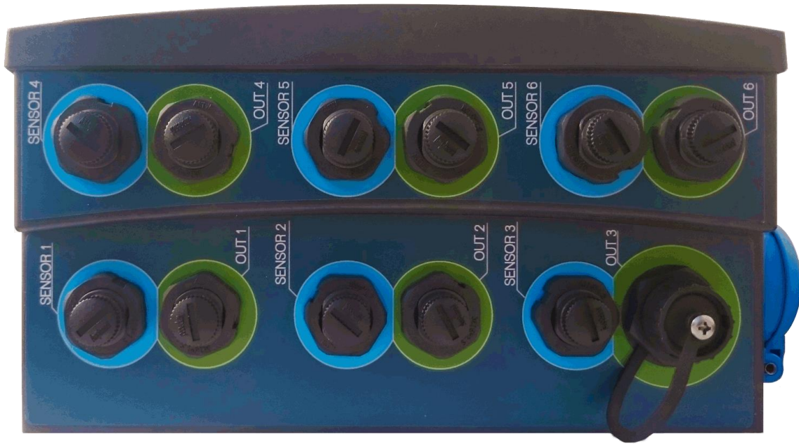
Abbildung 3: Sensoren-Anschlüsse und Aktoren-Ausgänge der AQUACULTURE|CONTROL Pro.
